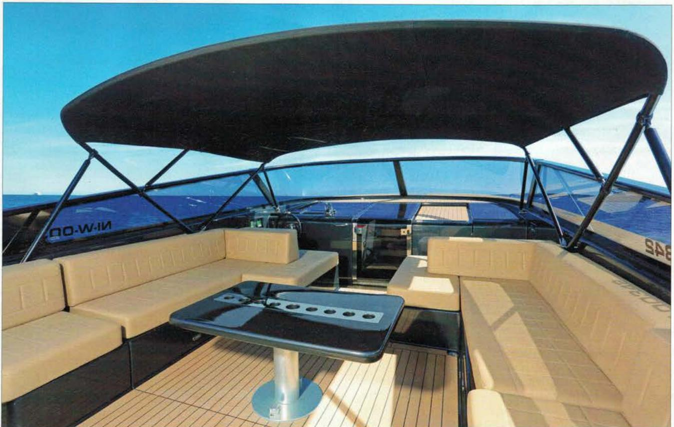
Le bimini taille basse est l'une des rares concessions à la complexité mécanique. L'ensemble de la capote se déploie électriquement.
