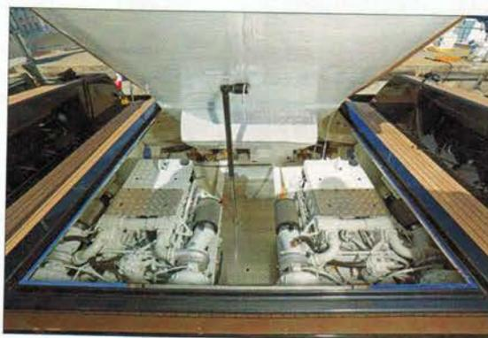
La salle des machines, bien insonorisée, accueille deux Yanmar de 900 ch avec des transmissions V-drive en ligne d'arbre.
